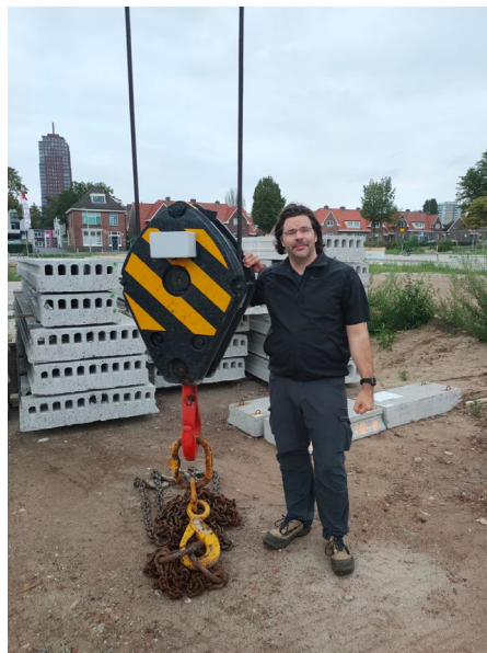
Bild - Beispiel einer Tracking & Tracing Box, welche aktuell mittels der REST Schnittstelle an milliways angebinden wird
